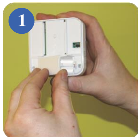
1 Zložte kryt batérie zo zadnej strany jednotky iT300.
