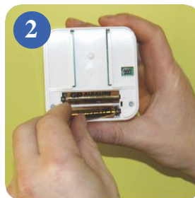
2 Do jednotky iT300 vložte 2 priložené batérie AAA.
