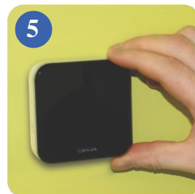
5 Po nasunutí skontrolujte, či jednotka pevne drží.
